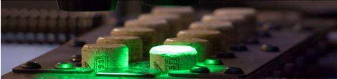
Micro Blue est un bouchons technique composé par des granulés fins compactés, extraction des TCA à la vapeur et avec la membrane technique ProCork™ pour protégé le vin des TCA et des goûts de colle.
